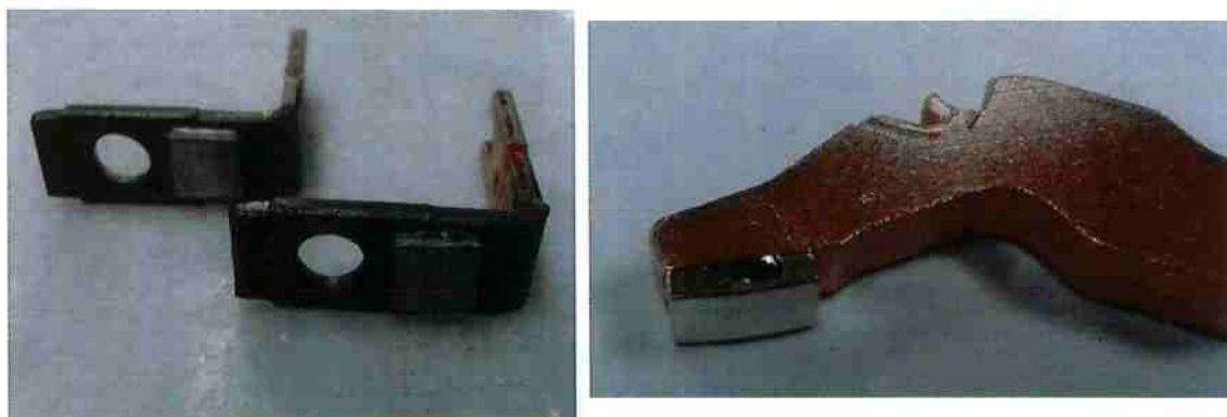
Figura 23: Exemplos de conjuntos elétricos. Pastilha de prata brasada em base de cobre
