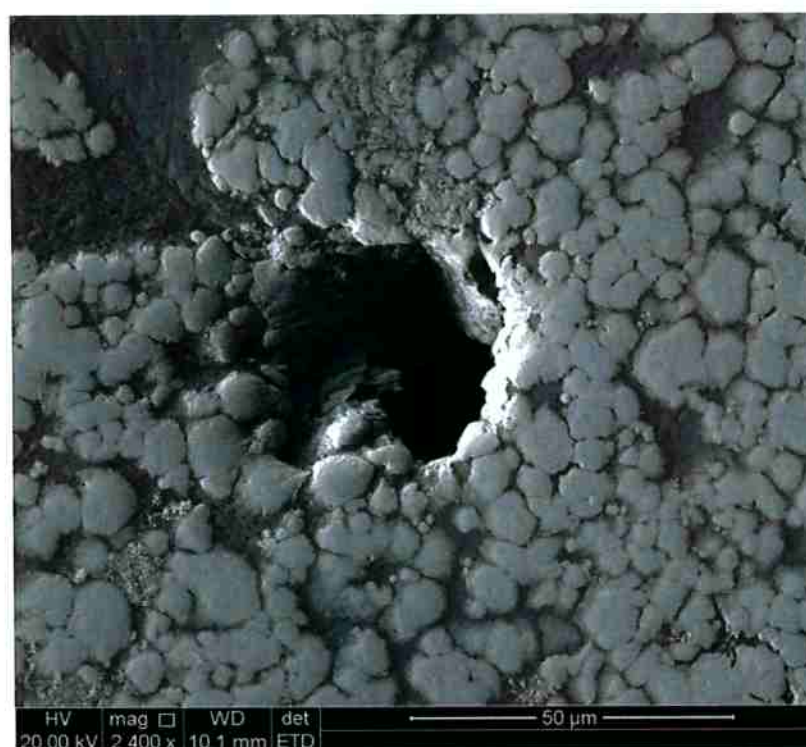
Figura 63: Porosidade num eletrodo de composição teórica 50% Cu - 50% W. . Microscopia eletrônica de varredura, sem ataque.
