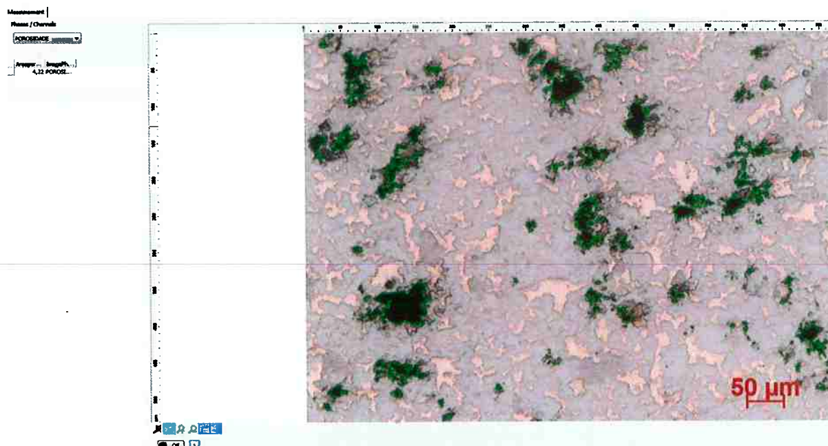
Figura 68: Quantificação de porosidade no eletrodo de composição teórica 40% Cu – 60% W. 4,2% de porosidade
