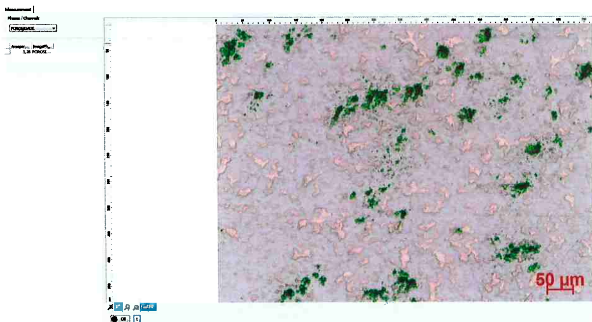
Figura 67: Quantificação de porosidade no eletrodo de composição teórica 35% Cu - 65% W. 3,3% de porosidade
